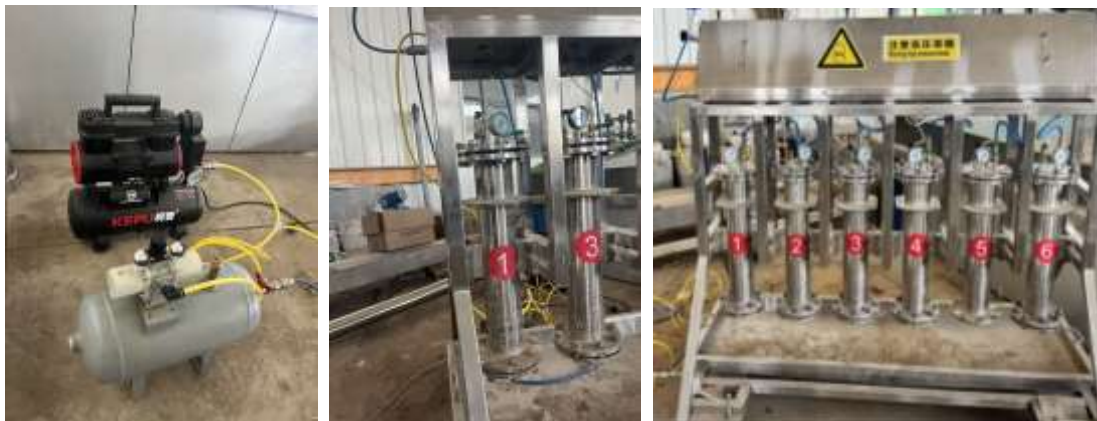
图 10 泥沙淤积固结可控压力试验装置
